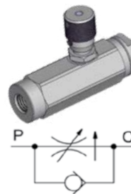
REGULADORES DE CAUDAL 2 VIAS COMPENSADO CUERPO ACERO 2-WAY COMPENSATED FLOW CONTROL VALVES STEEL BODY RÉGULATEUR DE DÉBIT 2 VOIES COMPENSÉ CORPS ACIER
